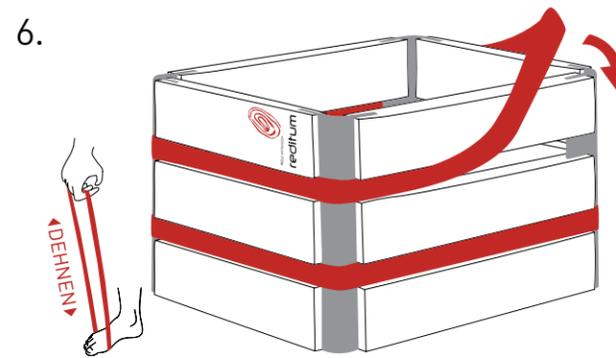
Wiederhole Schritt 1 und 2 mit den **gelochten** Winkeln. Danach einfach den fertigen "Deckel" aufstecken, festdrücken und zum Schluß den Schlauch herumziehen. Fertig!
